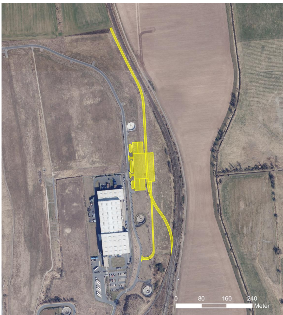
Abbildung 1: Geplante Verladestation mit Gleisanbindung (gelb) im Luftbild vom 25.03.2022 (Quelle: TLBG).
